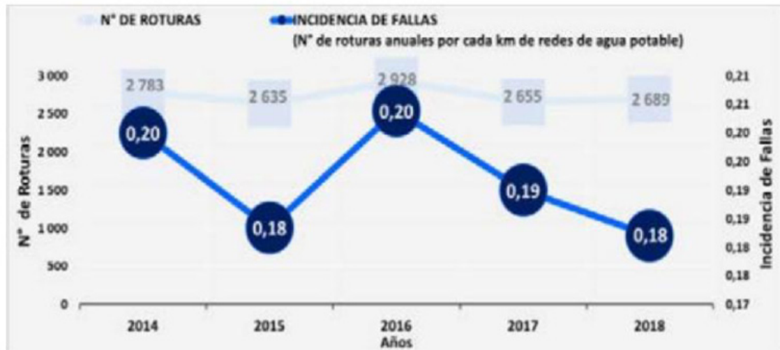
Figura 1. Incidencia de fallas en redes de agua potable (en N° de roturas por km) Fuente: Memoria Anual 2018.
